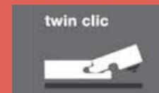
L'incastro Twin Click è stato disegnato per permetterti di installare il tuo pavimento nella maniera più semplice possibile. Il Clic ti permette di installare le doghe una con l'altra in maniera individuale utilizzando pochi attrezzi e senza complicazioni.
